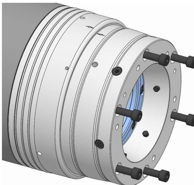
4. Allentare le viti di fissaggio dell'unità funzionale e rimuoverle.
