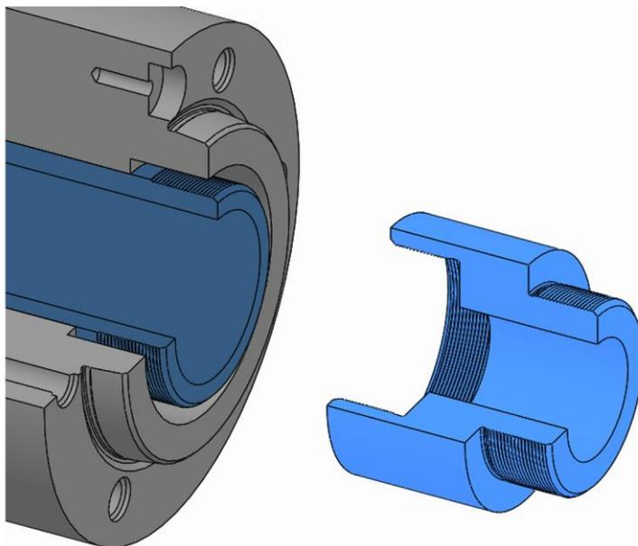
1. Se l'adattatore al tirante è stato montato sul tirante della macchina, svitarlo dal tirante della macchina per mezzo del suo filetto.
