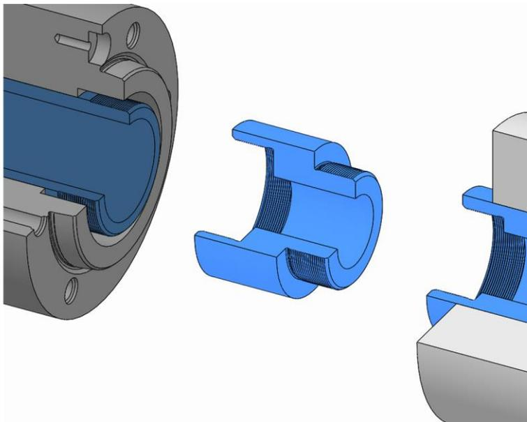
1. Avvitare l'adattatore al tirante nell'unità funzionale per mezzo del filetto o avvitarlo sulla macchina e serrare a fondo.
