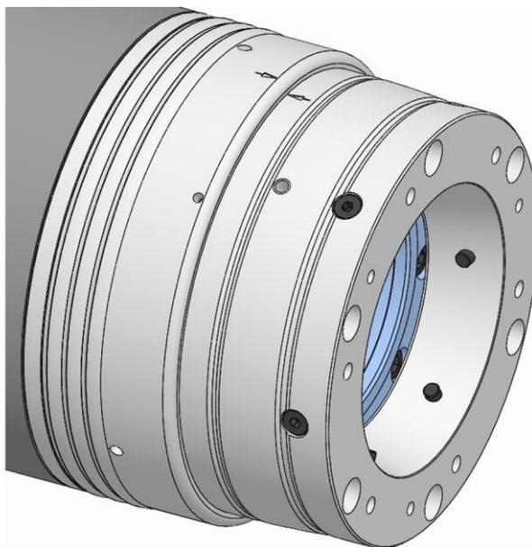
5. Ruotare l'unità funzionale in senso contrario fino a quando le marcature di bilanciatura sulla flangia mandrino coincidono con quelle dell'unità funzionale.
