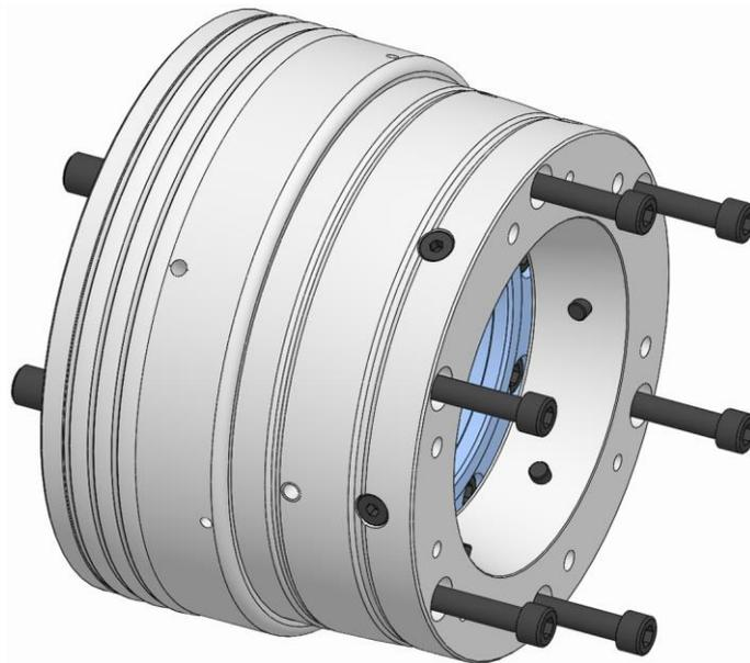
2. Allentare le viti di fissaggio dell'unità funzionale e rimuoverle.
