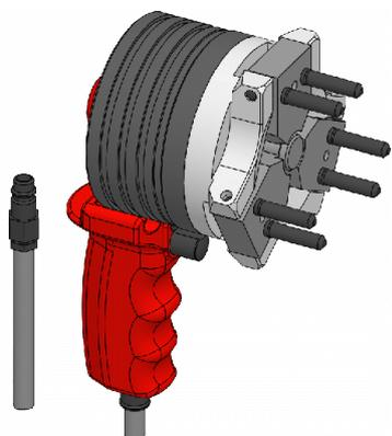
Le spine dell'attrezzo per cambio pinze vengono introdotte nei fori per il cambio nella pinza di serraggio. L'attrezzo per cambio pinze viene azionato tramite aria compressa. A seconda della grandezza, l'attrezzo per cambio pinze è concepito per l'azionamento a una o due mani. La pinza di serraggio è bloccata nell'attrezzo per cambio pinze, per mezzo del quale può essere introdotta nel mezzo di serraggio montato.
